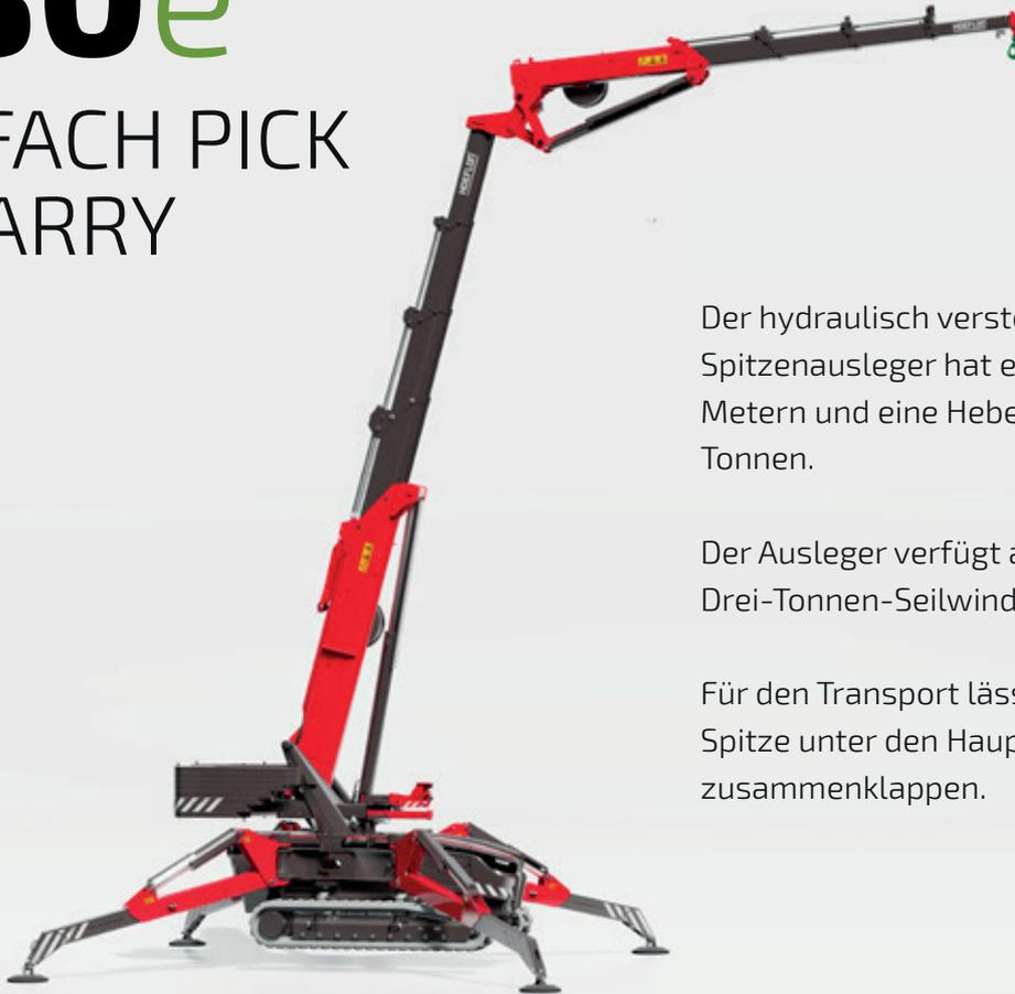
Der hydraulisch verstellbaren Spitzenausleger hat eine Länge von sieben Metern und eine Hebekapazität von drei Tonnen.
